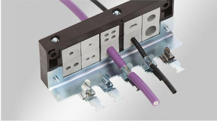
Zur Ableitung schirmgebundener Störungen unmittelbar an der Kabeleinführungsleiste. Die Leitungen werden mittels Kabelbinder über den Kabelaußenmantel zugentlastet. Die Kontaktierung des Schirms erfolgt unmittelbar an der Gehäuse-/Schaltschrank-Innenseite.
